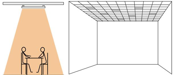
Empfehlung: Thermocassette kann in Zwischendecken bündig montiert werden. Wenn Thermocassette für die Vollheizung verwendet wird, sollten die Geräte wie in der Abbildung gezeigt über die Decke verteilt werden.
