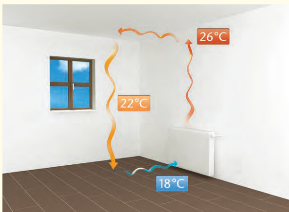
Temperaturverlauf und Thermik bei herkömmlichen Konvektions-Heizsystemen
