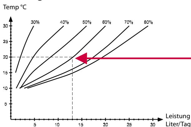
Vergleichen Sie bei der Wahl eines Entfeuchters die Leistung an einem normalen Arbeitspunkt. Dieser liegt bei 20°C und 60% r.F. (Leistung bei 30°C und 80% r.F bei normaler Verwendung ist nicht interessant).
